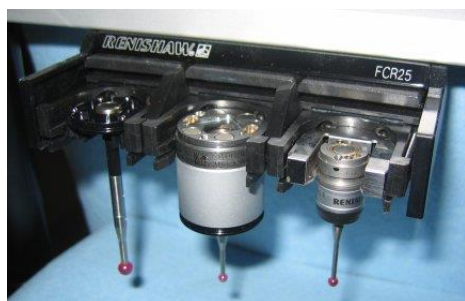
Insertos y tipos de sondas del cambiador de sondas FCR25
