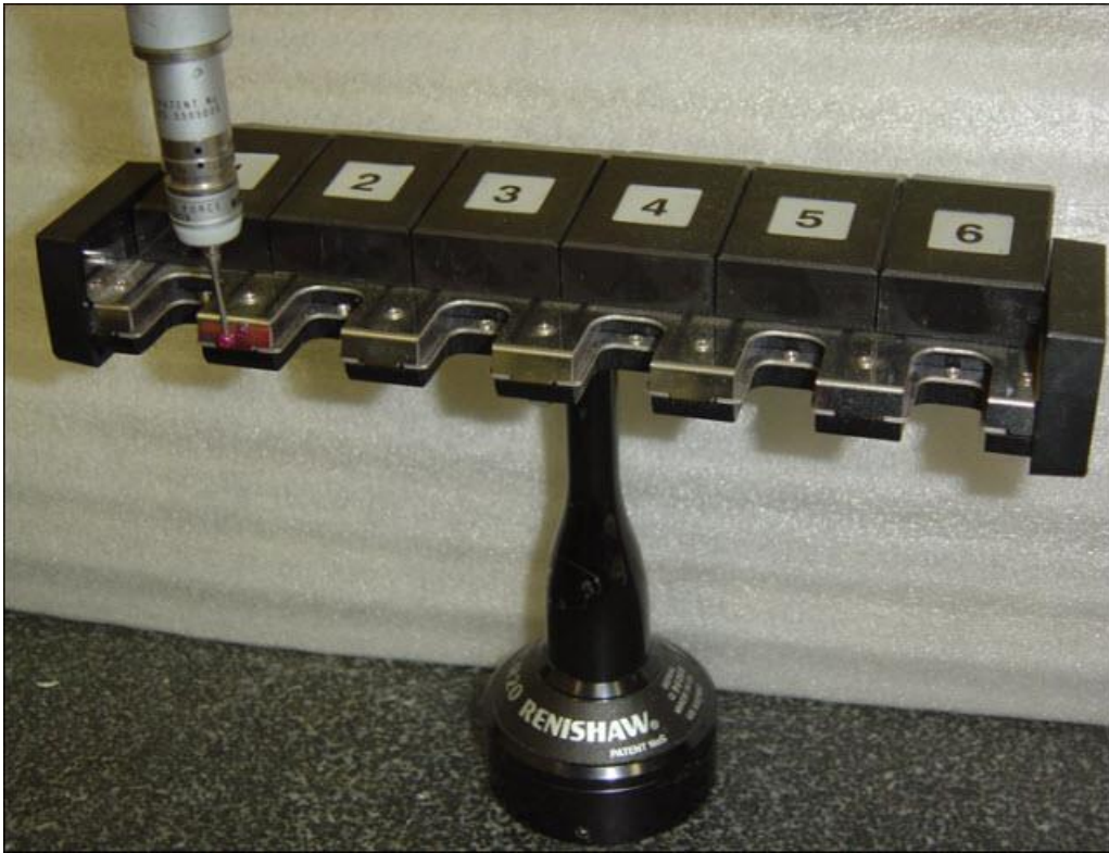
Ejemplo que muestra la ubicación del primer contacto manual durante la calibración de TP20.
