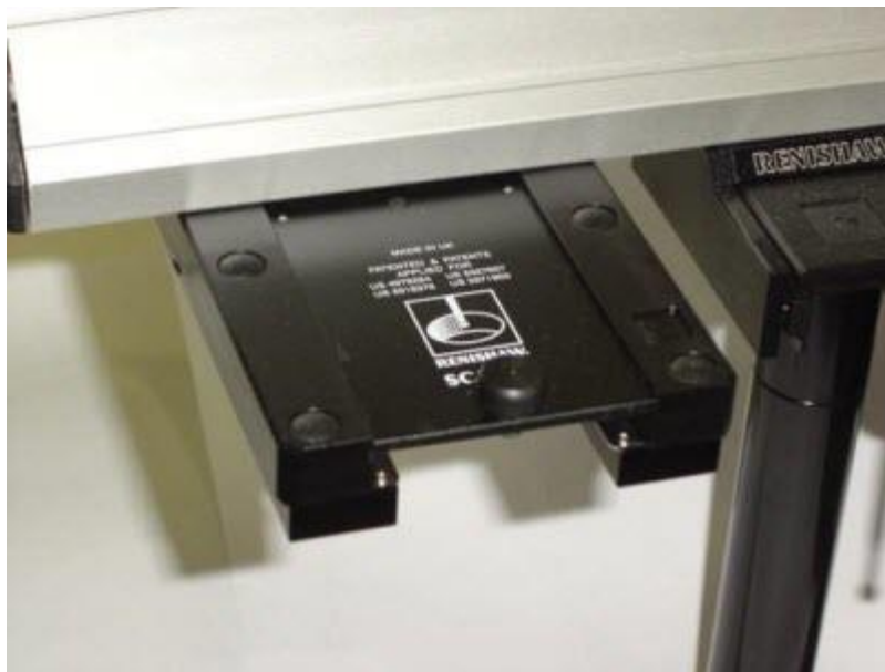
Un cambiador de palpadores Renishaw SCP600
