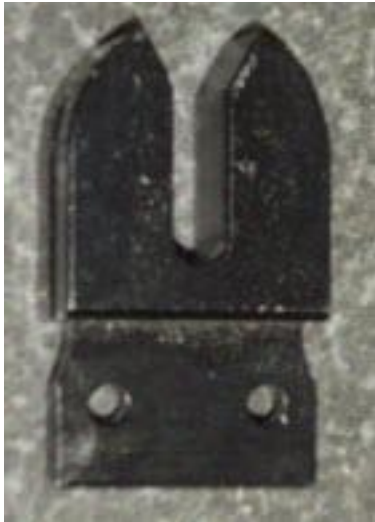
Ejemplo de una galga de ajuste.
