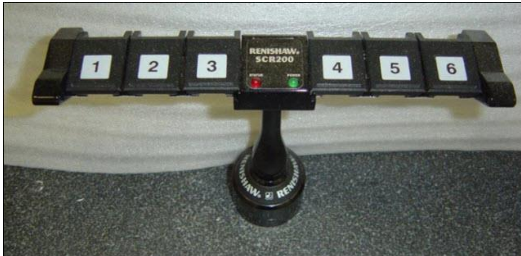
Cambiador de sondas TP200
