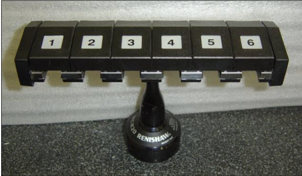
Cambiador de sondas TP20
