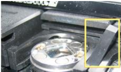
Galga que mantiene abiertas las tapas de dos puertos
