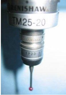
Módulo TM25-y palpador de tipo TP20
