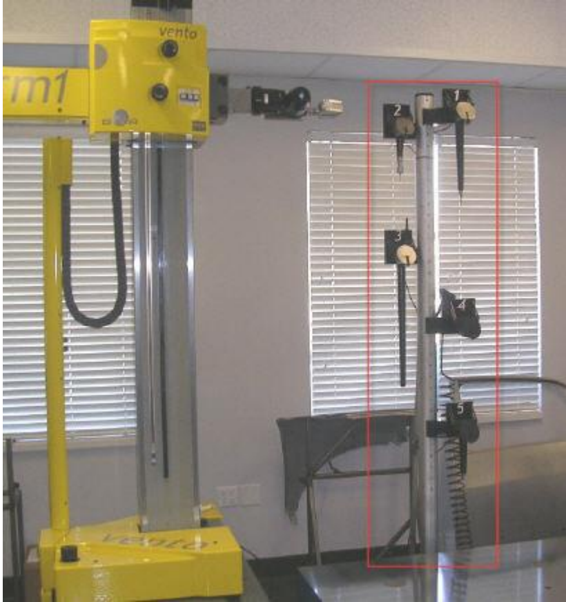
Cambiador de sondas CW43 vertical con cinco puertos
