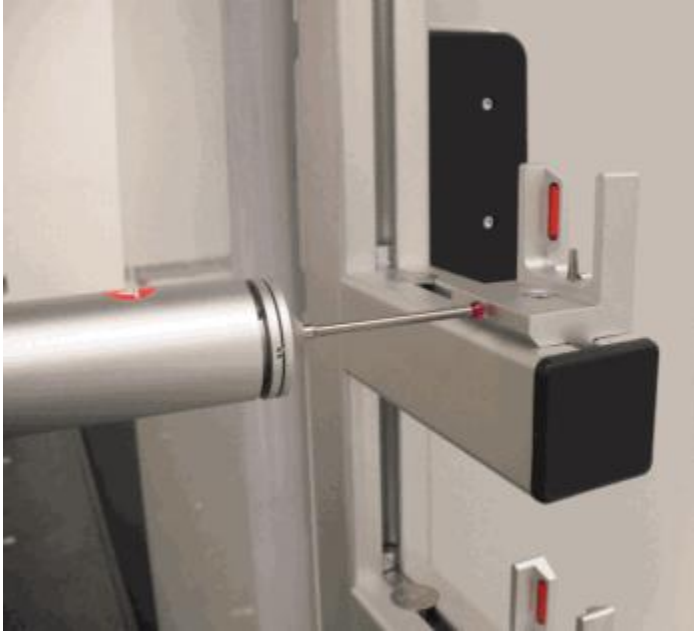
Contacto horizontal en la superficie plana y vertical frontal del puerto superior
