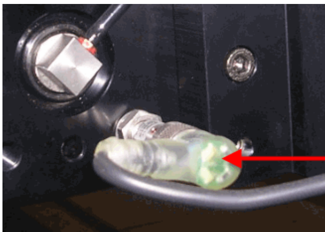
Conexión electromagnética con luces de LED verde y ámbar LED
