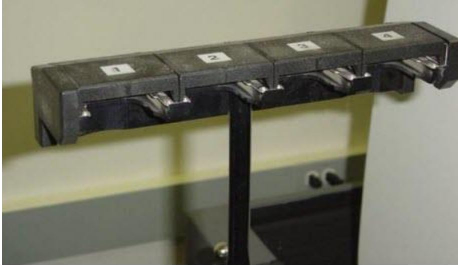
Un cambiador de palpadores Renishaw SCP600 (SCR600)
