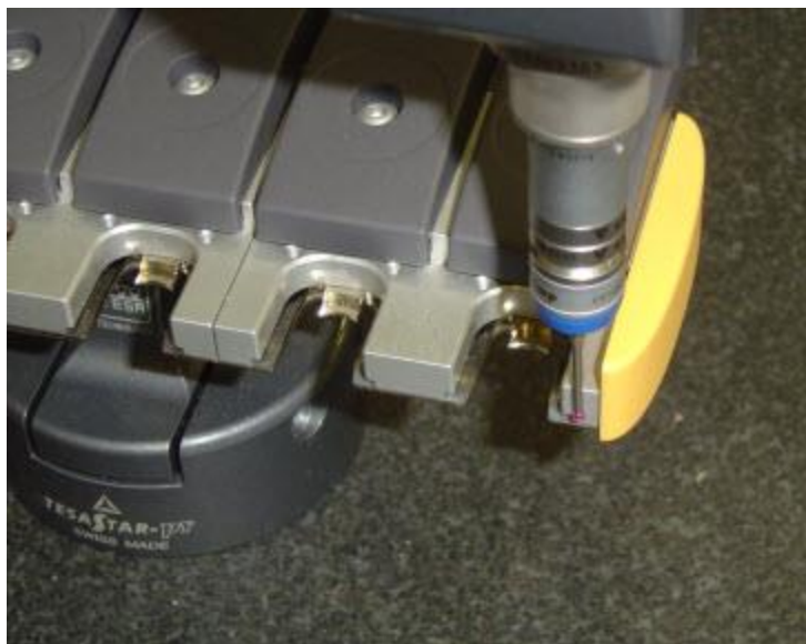
Ubicación del segundo contacto manual durante la calibración
