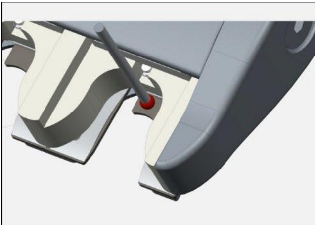
Vista del cuarto contacto en la superficie superior de la lengüeta de soporte de la sonda en la parte posterior del puerto
