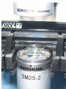
Posición centrada por encima del puerto 2
