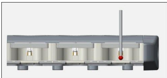
Vista del primer contacto en la superficie posterior del puerto 3
