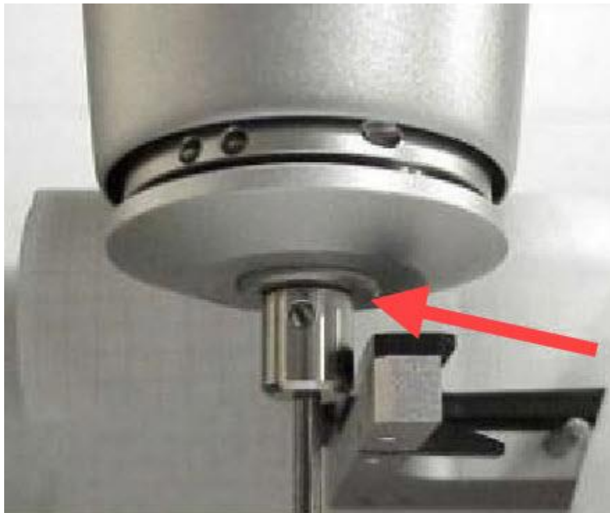
Ubicación del primer contacto para el puerto 1 en el alero de la pinza
