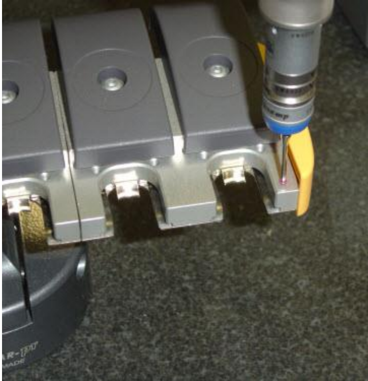
Ubicación del tercer contacto manual durante la calibración
